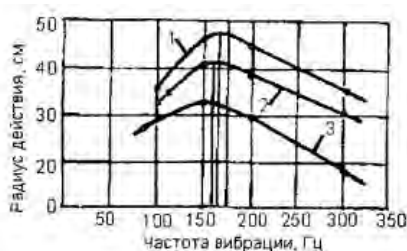
Рисунок 4.3 - Влияние частоты колебаний на радиус действия глубинных вибраторов:
