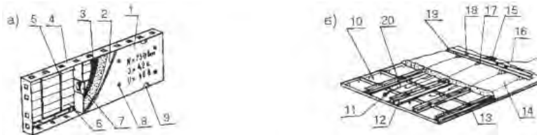
Рисунок 2.17 - Стальная термоактивная опалубка (конструкция ЦНИИОМТП)
