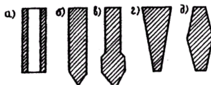
Рис.13. Продольный профиль железобетонных свай:
