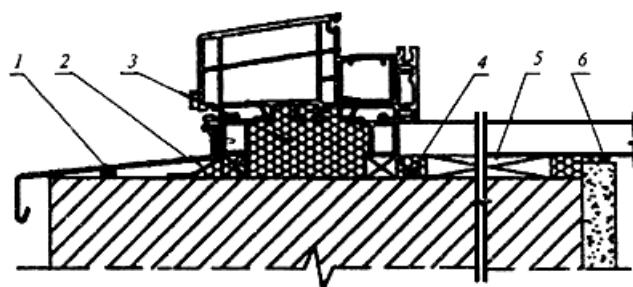
Рисунок 30. Монтажный шов в нижнем узле примыкания оконной коробки, подоконника и отлива в проеме однослоевой стены:
