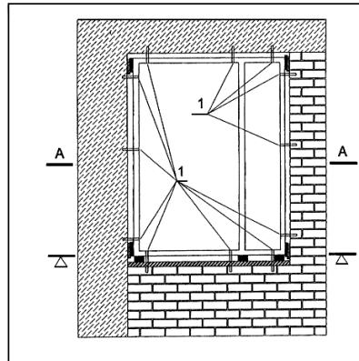
Рисунок 16. Схема расположения точек крепления коробки оконного блока в стеновом проеме:
