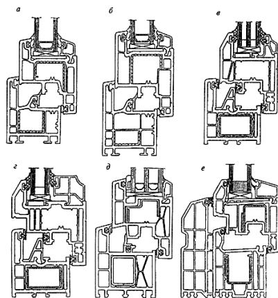
Рисунок 5. Узлы основных притворов с различными видами уплотнений:
