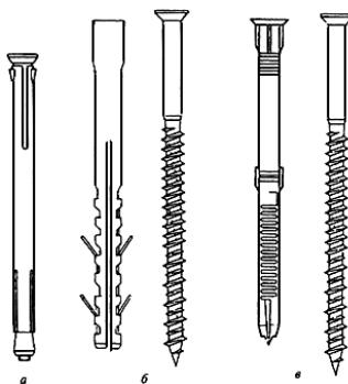
2.7.32. Пластмассовые дюбели со стопорными шурупами применяют для крепления оконных блоков к стенам из кирпича с
