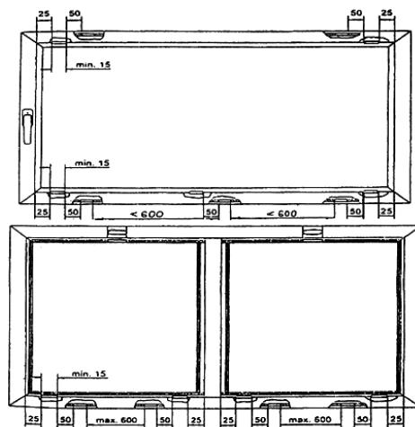
Рисунок 8. Расположение функциональных отверстий
