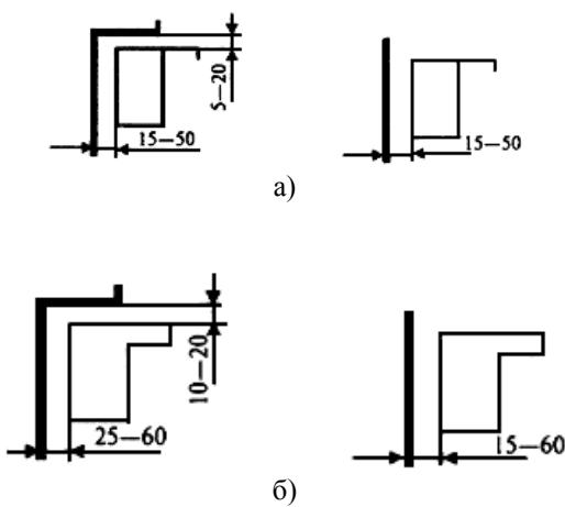
Рисунок 21. Размеры монтажных зазоров (швов) при установке оконных блоков:
