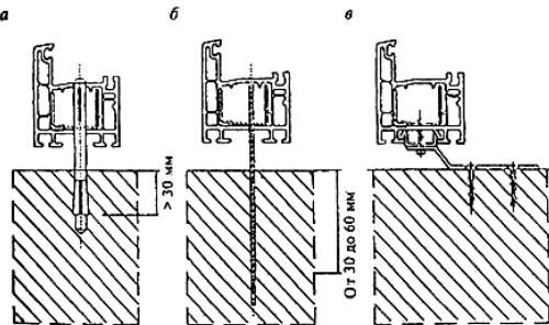
Рисунок 18. Варианты узлов монтажных креплений:
