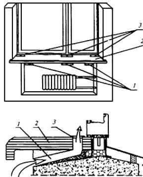
Рисунок 33. Схема нижнего узла примыкания с каналом подачи теплого воздуха от нагревательного прибора к оконному блоку:
