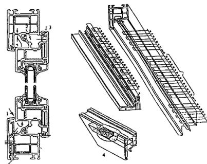
Рисунок 9. Система внутрипрофильной канальной самовентиляции:
