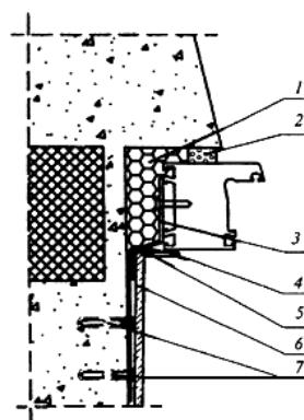
Рисунок 28. Узел бокового примыкания оконного блока к проему стеновой панели с отделкой внутреннего откоса панелью:
