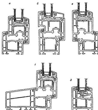
Рисунок 4. Узлы основных притворов с внутренним и наружным уплотнениями:
