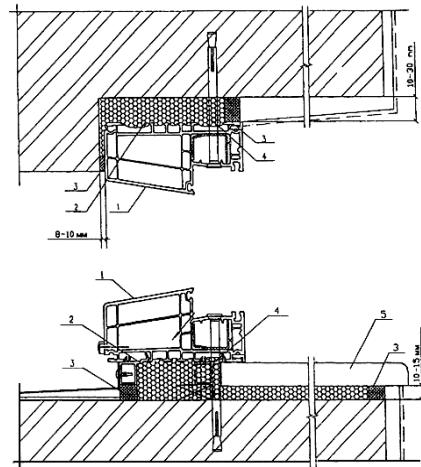
Рисунок 35. Пример монтажного узла оконного блока:
