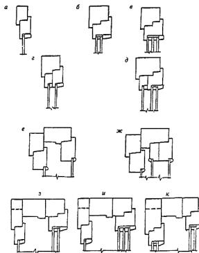
Рисунок 1. Основные типы конструкций и варианты заполнения светопрозрачной части оконных блоков:
