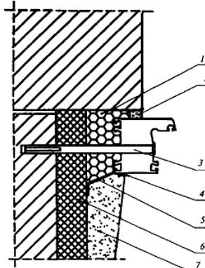
Рисунок 22. Узел бокового примыкания оконного блока к проему с четвертью в стене из кирпича, с отделкой внутреннего откоса штукатурным раствором:
