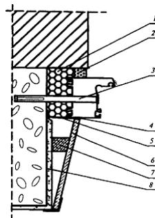
Рисунок 26. Узел бокового примыкания оконного блока к проему с четвертью в стене из ячеистобетонных блоков (плотностью 400-450 кг/м<sup>3</sup>) с облицовкой кирпичом и отделкой внутреннего откоса панелью:
