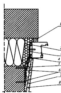
Рисунок 23. Узел бокового примыкания оконного блока к проему с четвертью слоистой стены из кирпича с эффективным утеплителем и отделкой внутреннего откоса штукатурным раствором:
