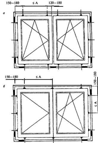
Рисунок 20. Примеры расположения опорных (несущих) колодок и крепежных деталей:
