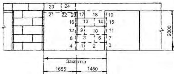
Цифрами 1 - 24 обозначена последовательность установки плит облицовки
