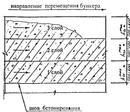
Рис.2. Схема послойного бетонирования
