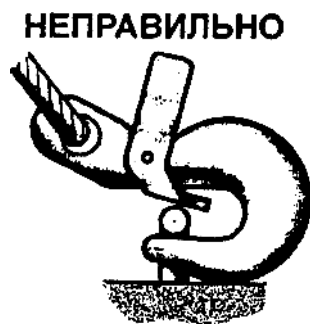
Рис.42. Установка палочного крюка в проушине неправильно
