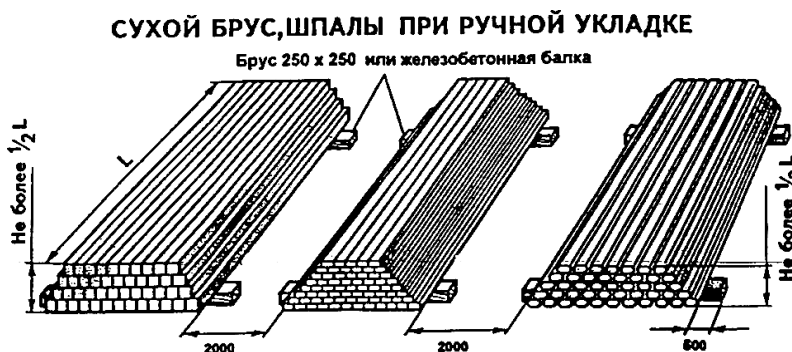
Рис.51. Складирование сухого бруса, шпал при ручной укладке
