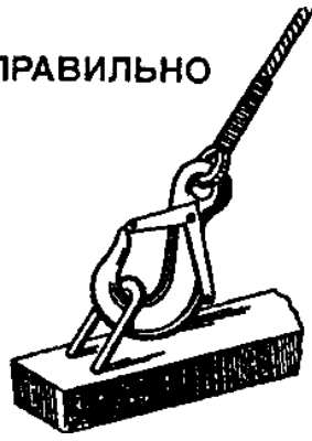
Рис.43. Установка палочного крюка в проушине правильно
