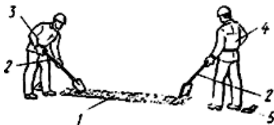
Рис.17. Схема подготовки растворной постели
