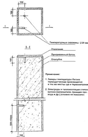
Рис. 6. Расстановка температурных скважин при термообработке колонн
