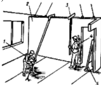
Рис.19. Схема выверки панели по вертикали
