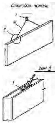
Рис. 21. Схема строповки конструкций:
