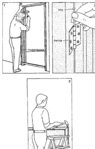
Рис.9. Крепление дверной коробки к стене
