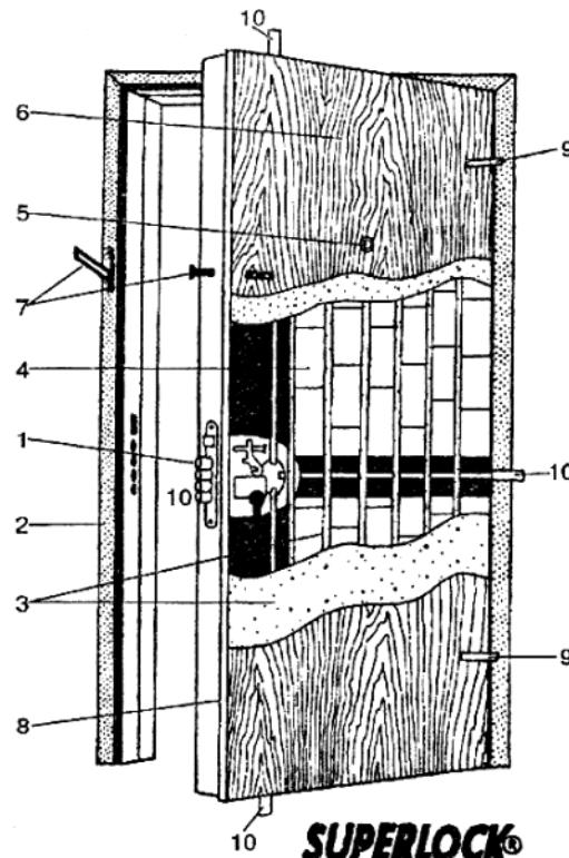
Рис.1. Конструкция двери производства завода"Superlock"
