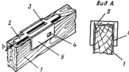
Рис.5. Шаблон для разметки гнезд замка:
