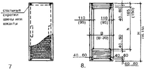
Рис.3. Примеры заполнения щитов дверных полотен (продолжение):
