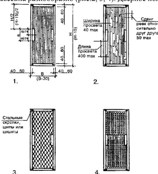
Рис.2. Примеры заполнения щитов дверных полотен:
