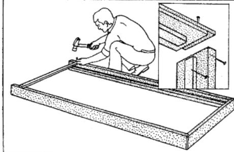
Рис.8. Сборка и установка дверной коробки
