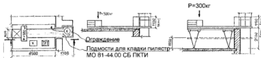
Рис.30. Кирпичная кладка пилястр
