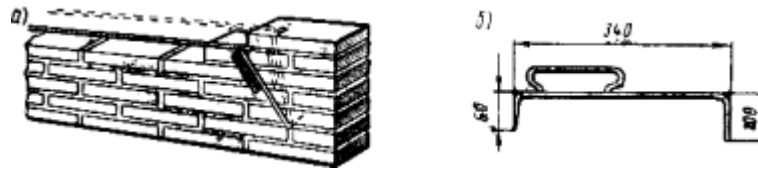
Рис.6. Установка и перестановка причалки
