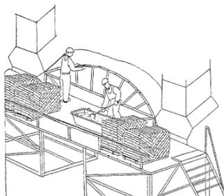
**Рисунок 7 - Разметка места укладки кирпичей по опалубке**
