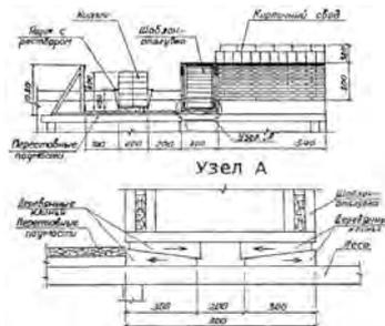
Рисунок 6 - Схема установки и демонтажа шаблона-опалубки
