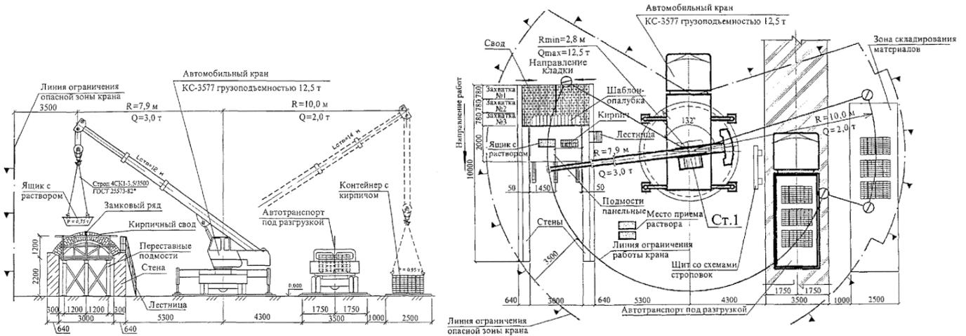
Рисунок 4 - Схема организации работ
