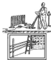
Рис.4. Вентилирование колодца с помощью вентилятора
