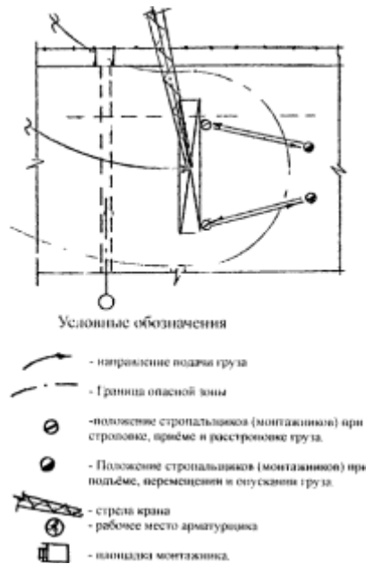
Рис.7. Подача арматуры к рабочему месту
